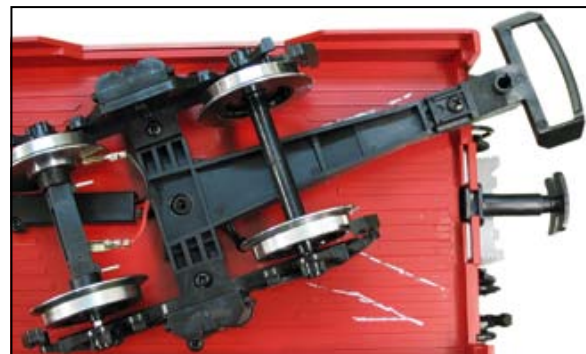
Blick unter einen LGB-Panorama-wagen im Lieferzustand. Der Schwenkradius der Deichsel ist weiß markiert.
