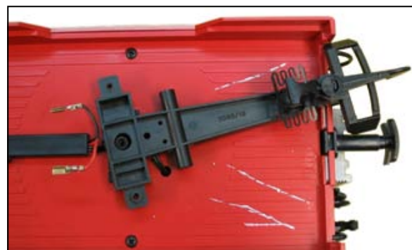
Einsatz der kurzen LGB-Deichsel 3080 / 19 eines US-Plattformwagens von LGB. Der Schwenkbereich verkleinert sich, weil die breite Standardöse am Wagenkasten aneckt.
