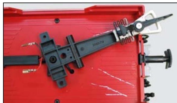
Die S-Kuplix-Öse ermöglicht den vollen Schwenkbereich auch bei Verwendung der kurzen US-Wagendeichsel oder einer gekürzten RhB-Deichsel. Der Puffer ist noch ungekürzt.
